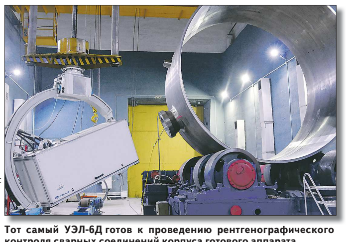
Тот самый УЭЛ-БД готов к проведению рентгенографического контроля сварных соединений корпуса готового аппарата
